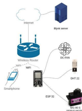
Gambar 1. Sistem implementasi dari sensor, ESP32, Blynk dan Smartphone
