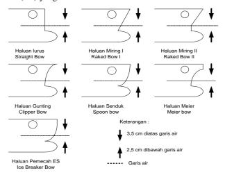
Gambar 1. Skema alat Skema Alat 7 Haluan aplikasi bulbous
