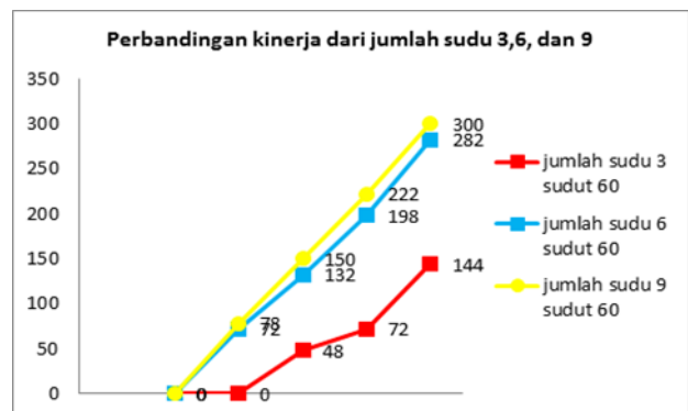
Gambar 5. Grafik kinerja variasi suhu ruangan 30°, 35°, 40°, 50°, 60°C dari baling-baling vertikal dengan jumlah sudu 3, 6, dan 9 pada variasi sudut sudu 60°
