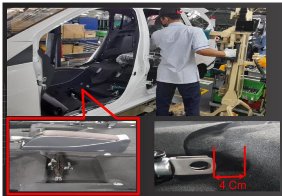
Gambar 1. Lokasi dan ilustrasi pemasangan pantograph manual Sumber: Penulis, 2024
