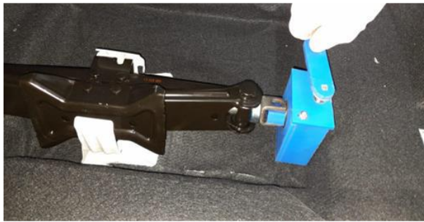
Gambar 4. Pemasangan Pantograph menggunakan SST
