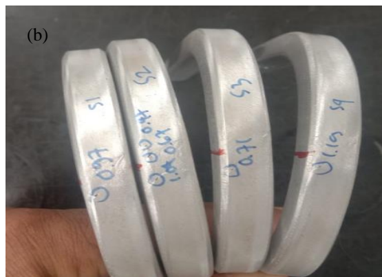
Gambar 5. Hasil uji tekuk tes kupon (a) 3G dan (b) 4G.
