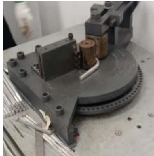
Gambar 2. Pengujian bending test dengan metode wraparound bend test jig.
