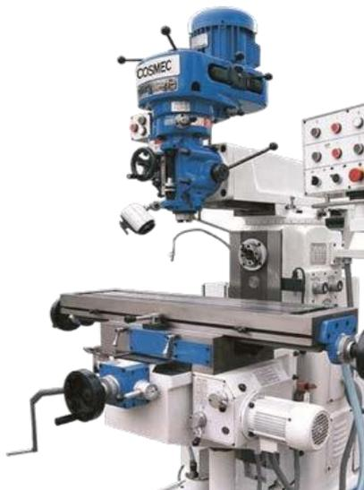
Gambar 4. Mesin Frais/ *Milling*
