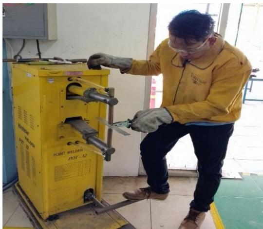
Gambar 3. Proses Pengelasan RSW
