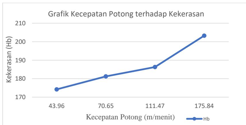
Gambar 14. Grafik Kecepatan Potong terhadap Kekerasan Material
