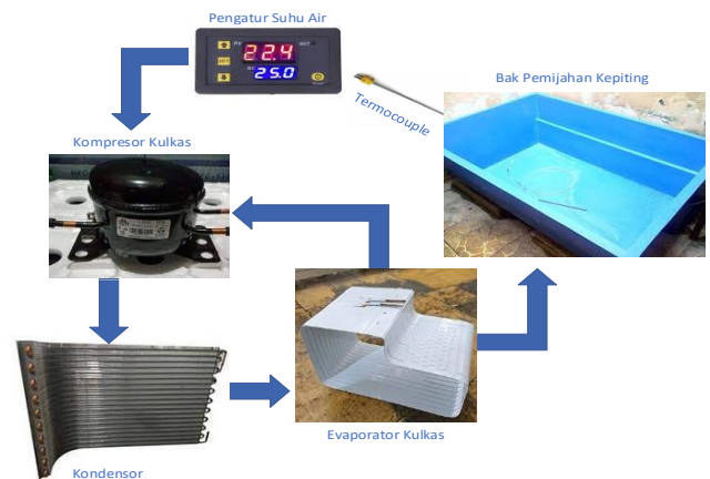
Gambar 1. Desain Pengkondisian suhu air pada pemijahan kepiting bakau
