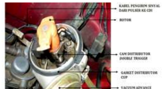
Gambar 7. Distributor Saat Akan Dipasang ke Engine Sesuai Top Kompresi
