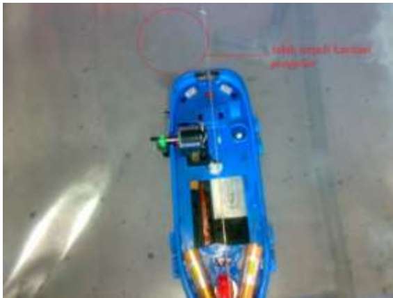
Gambar 10. Sudut kemiringan poros baling-baling 15^\circ
