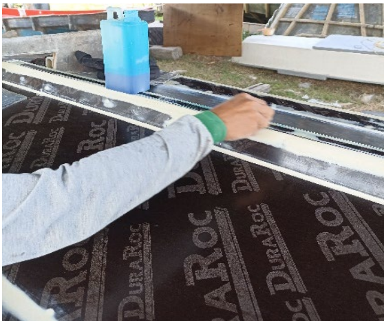
Gambar 2. Proses Pembuatan Kerangka Cetakan
