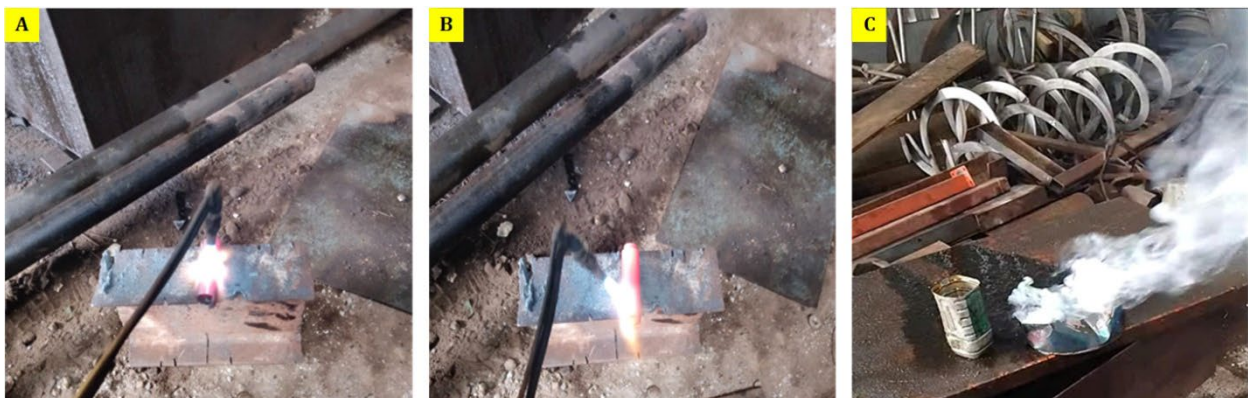
Gambar 1. (a) Pra Heating, (b) Pemanasan Titik Didih, dan (c) Pendinginan Besi Dengan Cairan Oli
