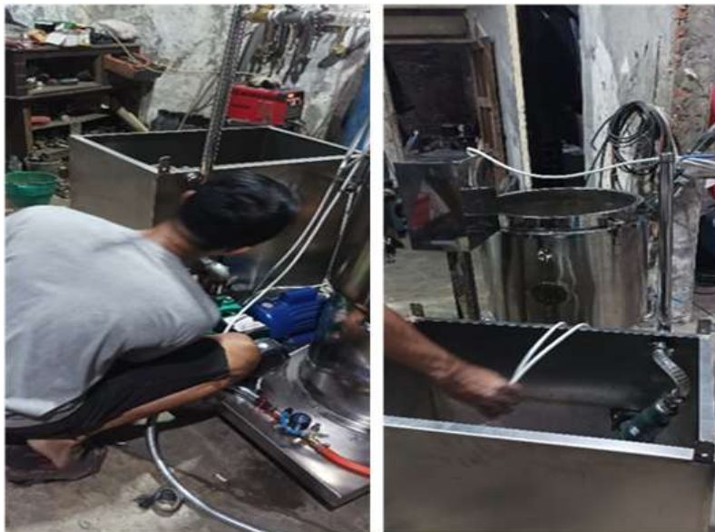
Gambar 3. Instalasi dan Uji Coba Dehydrated Honey Machine di Lokasi Mitra
