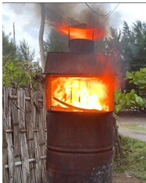
Gambar 1. Proses Pembakaran Sampah Dengan Oli Bekas
