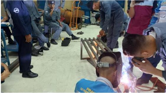
**Gambar 4.** Demonstrasi Pengelasan Menggunakan Las Listrik SMAW yang Melibatkan Peserta Secara Langsung di Welding Shop Politeknik Penerbangan Surabaya
