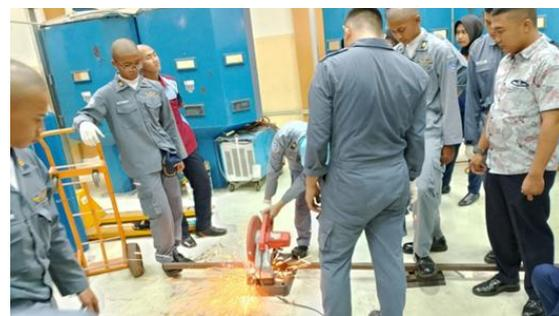
**Gambar 3.** Pemotongan Besi Sebagai Bahan Praktikum dalam Pengelasan Las Listrik SMAW
