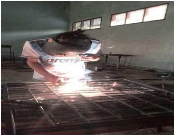
Gambar 3a. Penerapan APD Pada Pengelasan
