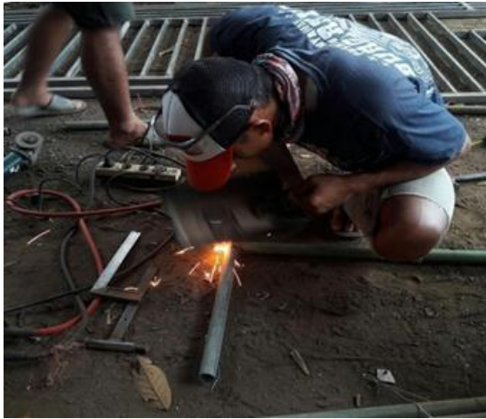
Gambar 2a. Pengelasan Tanpa Standart Keamanan
