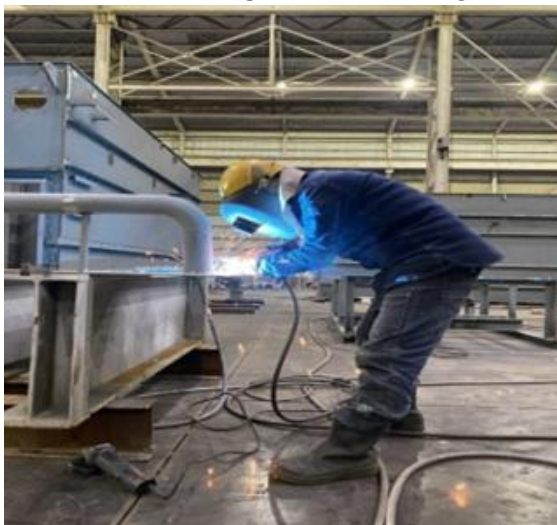
Gambar 3b. Penerapan APD Pada Pengelasan
