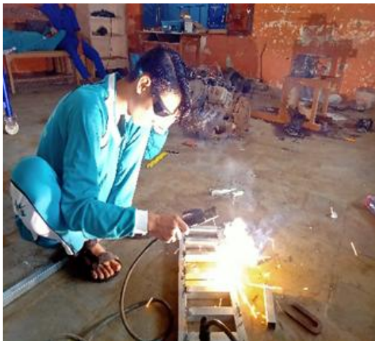
Gambar 2b. Pengelasan Pagar Tanpa Standart Keamanan
