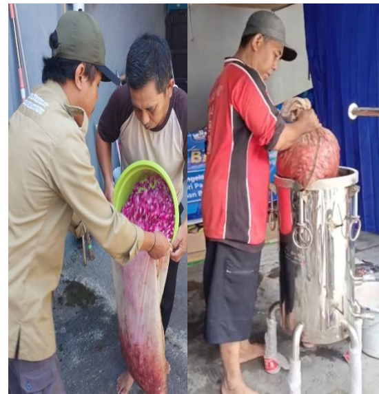
Gambar 2. Bahan bunga mawar dimasukkan ke Mesin Hidrodestilasi
