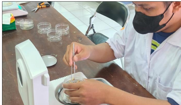
Gambar 3. Proses Analisis Kadar Air Odeng Ikan Menggunakan Moisture Meter
