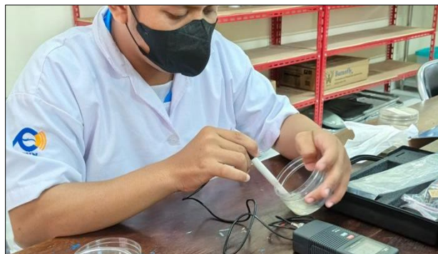
Gambar 5. Proses analisis kadar pH odeng ikan menggunakan pH meter
