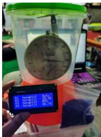
Gambar 4 Pengujian Kelembapan Sensor DHT22 dan Hygrometer
