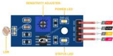
Gambar 5. Skematik Sensor LDR [15] Sensor LDR memiliki spesifikasi pin sebanyak 4 pin yaitu pin Vcc sebagai pin power (sumber daya), pin A0 berfungsi sebagai output data sensor pada pin analog, pin D0 berfungsi sebagai output data sensor pada pin digital dan pin Gnd berfungsi sebagai grounding.
