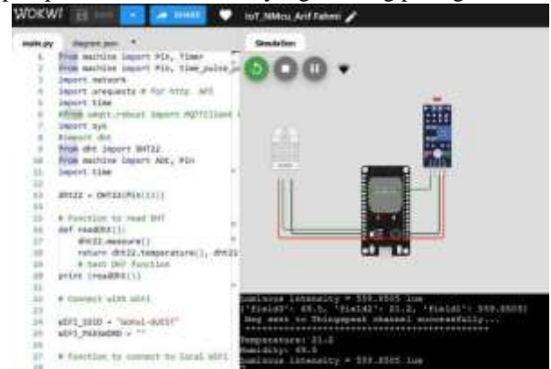
Gambar 11. Hasil Simulasi Rangkaian Mikrokontroler Esp32 Berdasarkan gambar 11 menunjukkan hasil simulasi rangkaian mikrokontroler Esp32 berjalan dengan baik dibuktikan dengan tampilan serial monitor berwarna hitam yang menampilkan hasil parameter sensor suhu sebesar 21.2C 0 parameter kelembapan udara sebesar 69.5% dan intensitas cahaya 559.8505 lux.
