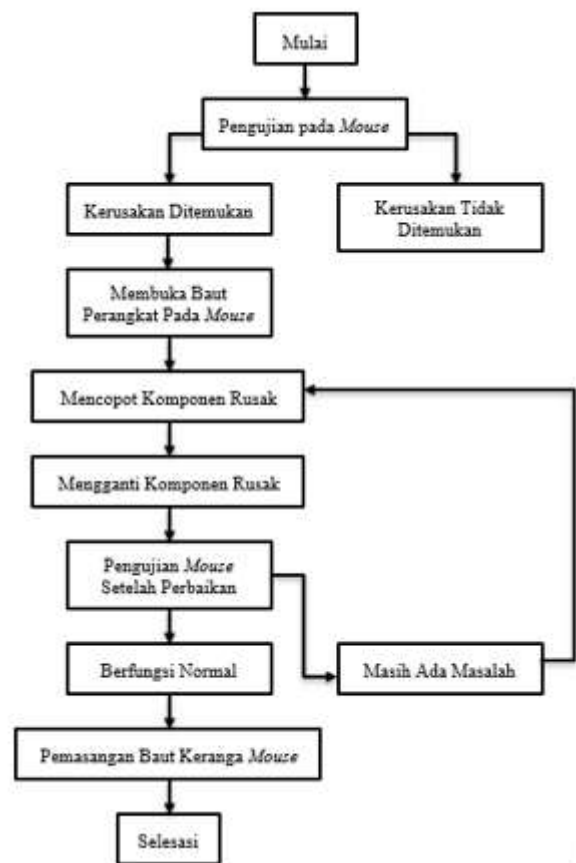
Gambar 7. Diagram Alir Memperbaiki Mouse
