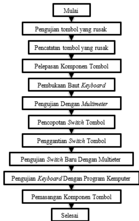
Gambar 3. Diagram Alir Memperbaiki Keyboard yang Rusak
