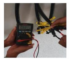
Gambar 2. Pengujian Tegangan Output String
