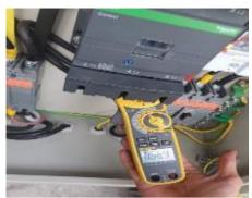
Gambar 5. Pengujian Arus Pada Terminal S
