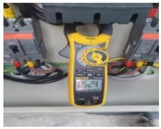
Gambar 6. Pengujian Arus Pada Terminal T
