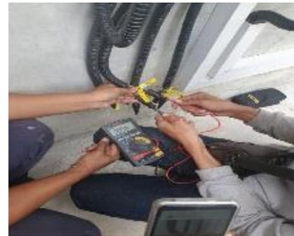
Gambar 3. Pengujian Tegangan String Kapasitas Lebih Besar
