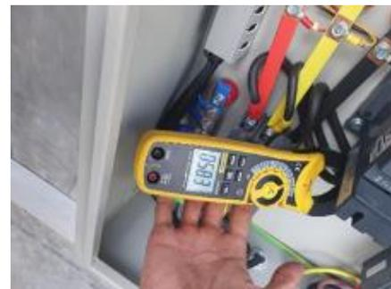
Gambar 4. Pengujian Arus Pada Terminal R
