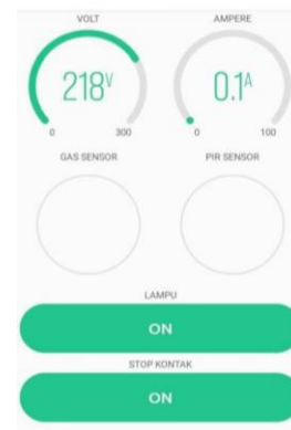
Gambar 8. Pengujian Sensor PZEM 004T beban (20 watt dan setrika) baru ON di aplikasi BLYNK
