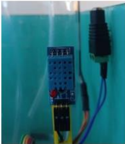
Gambar 5. Penempatan Sensor DHT11
