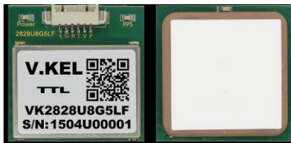
Gambar 3. GPS modul V.KEL. Sumber: Datasheet GPS modul V.KEL modul
