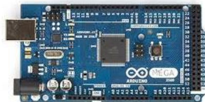
Gambar 2. Bentuk Mikrokontroler Arduino Mega 2560 Sumber: Datasheet Arduino Mega 2560
