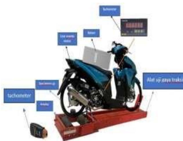
Gambar 1. Skema alat uji gaya traksi
