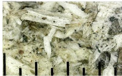
Gambar 7. Permukaan fisik komposit serbuk batang ukuran 30 mesh.
