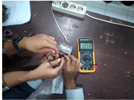
Gambar 3. Proses pengukuran transformator
